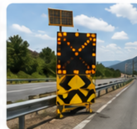
تجهیزات سولار و چشم‌گیرهای LED محور کندوان
